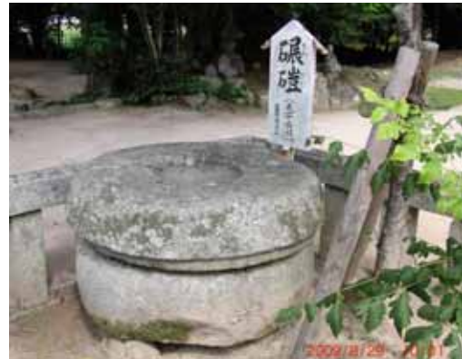
図 4 . 大宰府観世音寺の石臼 (天平年間) (直径 : 約 1 m、8 分画 6 溝。筆者撮影)
